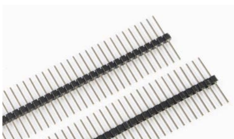
LINKS: Afbeelding 10.1c - Male-male connectorstrip voor 16-pins toepassing van de displays.
