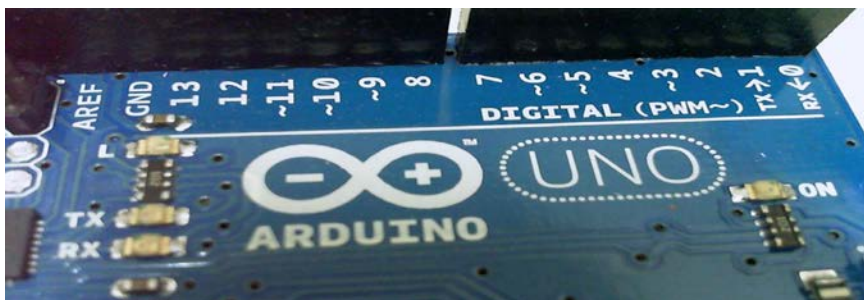
Afbeelding 11.13b – PWM is op de Arduino UNO-R3 uitsluitend beschikbaar op de met ~ gemerkte pinnen D3, D5, D6, D9, D10 en D11.
